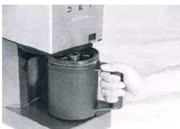
в) Выньте внешний контейнер из машины (вставленные ранее в машину разбрызгиватель с ножом остаются при этом на контейнере).
