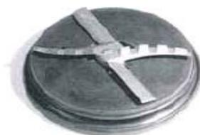
Возьмите собранный комплект по углам двумя пальцами и вставьте его вогнутой стороной в отверстие разбрызгивающего устройства машины до тех пор, пока хомут (втулка) комплекта из ножа и разбрызгивающего устройства не будет находиться над удерживающими «ушками» разбрызгивающего устройства машины. Убедитесь,
