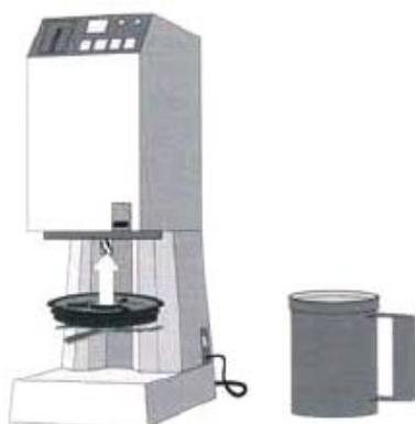
Теперь поместите собранный комплект из ножа и разбрызгивающего устройства наверх до полного упора, стыковки со спиралеобразным зубчатым соединительным элементом. Собранный комплект захвачен (схвачен) магнитом, который удерживает надежно (крепко) его вместе с разбрызгивающим устройством.
