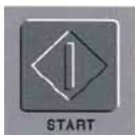
Кнопка запуска START предназначена для запуска фазы обработки продукта. Перед запуском машины:
