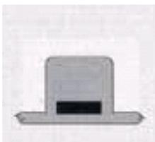
Кнопка удаления (отвода) воды расположена на фронтальной панели машины, снизу. После завершения процесса обработки хромированный стальной контейнер находится под давлением. Нажатие кнопки удаления (отвода) воды снимает давление из внутреннего хромированного стального контейнера, теперь внешний контейнер можно вынуть из машины.
